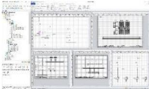
IEC-61850-gerecht: Durch [einfache grafische Verbindungen](#) mit den Intelligent Electronic Devices entstehen die logischen Knoten der einzelnen Geräte in EB von selbst. (Bild: Aucotec AG)
